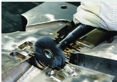
usuwanie osadu, nagaru i innych nalotów
