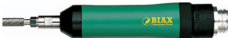
SRD 6-45/2 SL; 45.000 obr/min; 260 wat; 76 dB(A)
